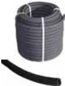
Offenporiger, wasserführender Schlauch, kann 10 bis 50 cm tief im Boden verlegt werden. Durch die Saugkraft der Erde und der Wurzeln wird das Wasser gleichmäßig verteilt. **Wasserdruck 0,2 bis 1 bar**, optimal: 0.6bar. Flexible Verlegungsmöglichkeit.
