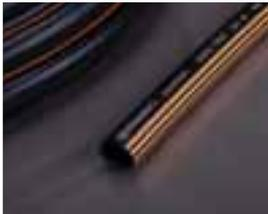
Euro Trix® ist ein EPDM Gummischlauch mit schwarzer, porenfreier, glatter EPDM-Innen- und Außenschicht. Außenschicht mit orangen Streifen. Der Druckträger ist synthetisches Garn. Er ist Ozon-, witterungs- und UV- beständig. Hochflexibel, drallfrei und knickstabil.
